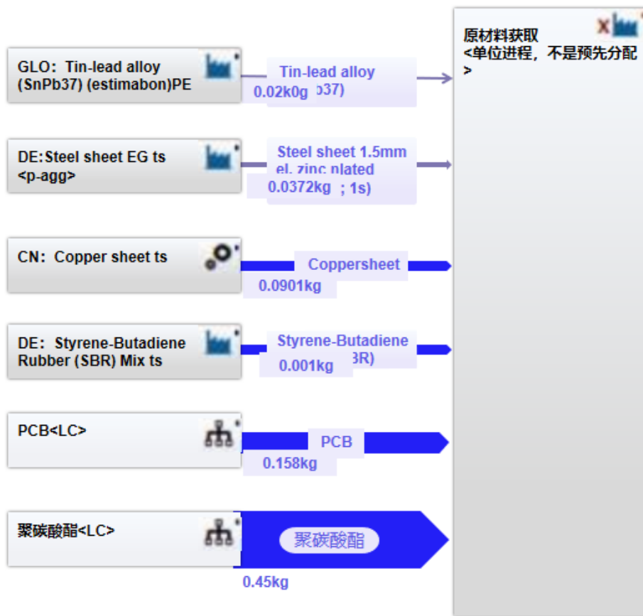
图 3.1.1 原材料获取阶段 LCA 模型
